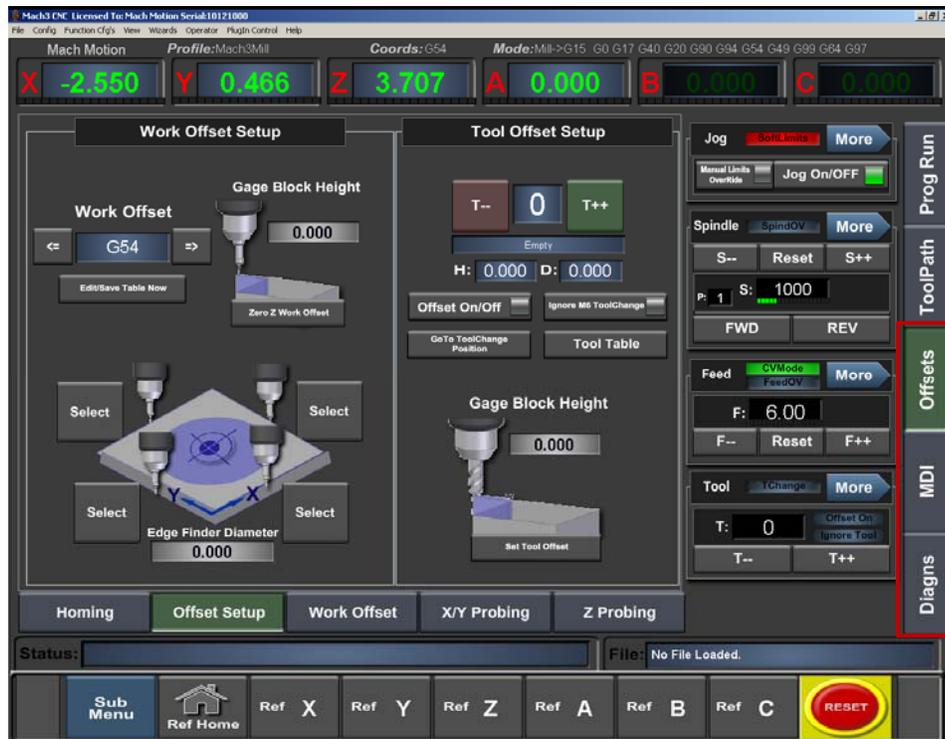
FIGURE 7 TOOL OFFSET SETUP UNDER THE OFFSETS TAB
